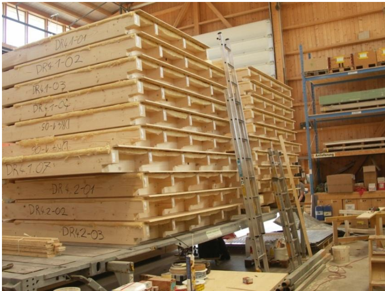
Bild mit Vordachelementen im Werk des Holzbauers
