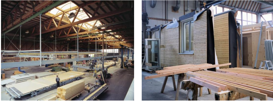
Abbildung 3: Produktion Wandelemente © Huber & Sohn
