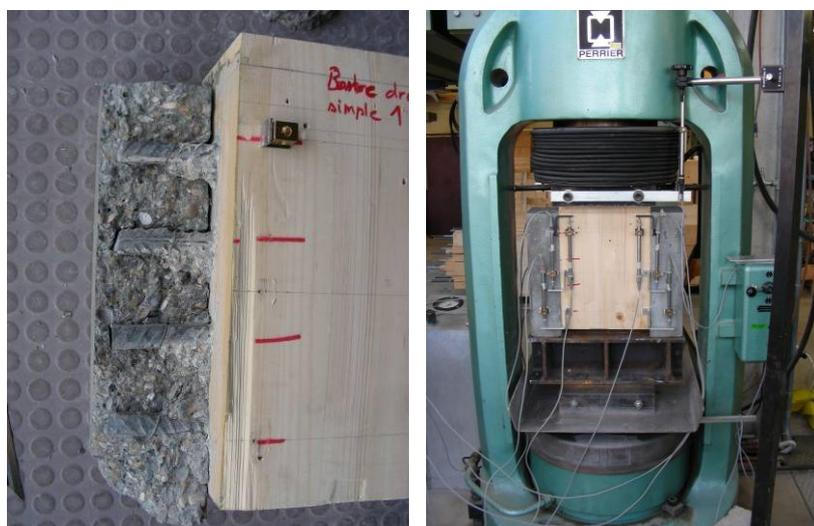
Figure 3: Essais Push-Out et éprouvette après rupture
