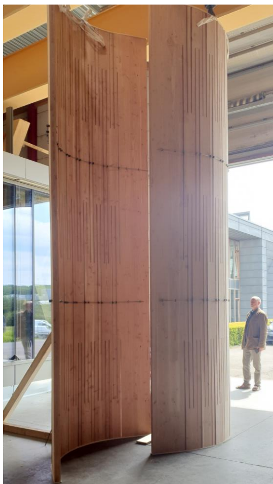
Prototype réalisé de deux panneaux de CLT cintré ©ArtBuild
