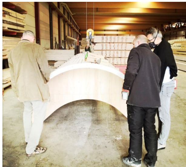
Dépose du panneau sur le mannequin de cintrage ©ArtBuild Consolidation du cintrage avec le plat métallique ©ArtBuild
