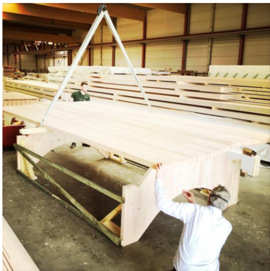
Dépose du panneau sur le mannequin de cintrage ©ArtBuild Consolidation du cintrage avec le plat métallique ©ArtBuild
