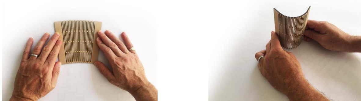
Principe du Lattice Hinge ©ArtBuild Maquette en MDF 8 mm d'épaisseur.
