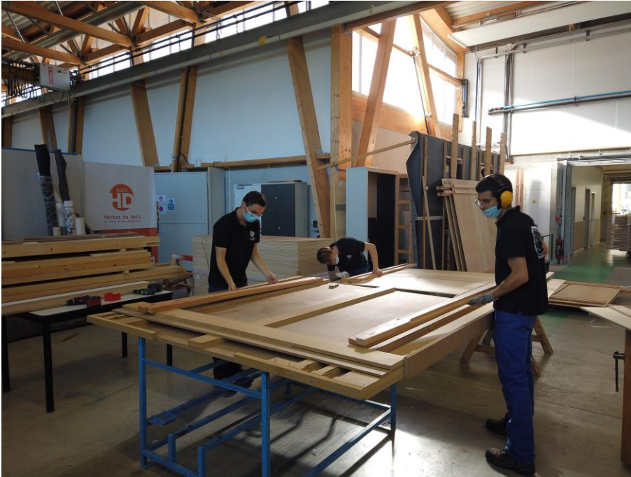
Poste de pose des traverses
