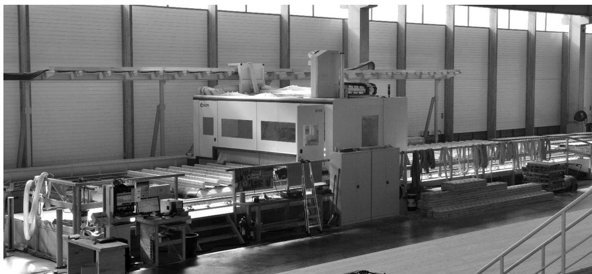
Figure 6 : Portique pour usinage des panneaux
