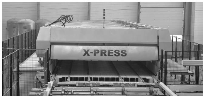
Figure 5 : Presse pour panneaux CLT
