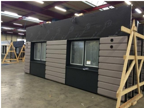
Panneaux de façades Panoblocs équipés du bardage et des châssis avant acheminement sur chantier
