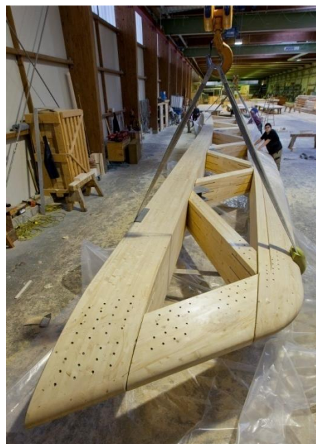
Illustration 16 : Poutre en treillis assemblée
