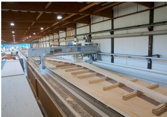
Illustration 15 : CNC avec fonctionnement à deux broches et dimensions d'usinage 6,00 x 78,00 m
