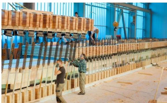
Illustration 12 : Collage en bloc des sections unitaires transversales
