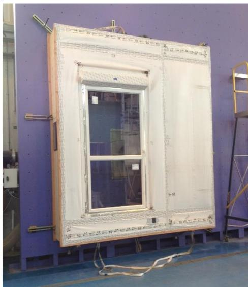
Prototype pour test AEV selon norme NF EN 13830
