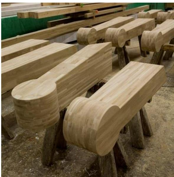
Illustration 7 : Poutres secondaires réalisées avec du collage bloc. Leur forme évoque le raisin.
