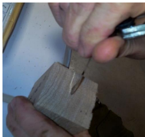
Illustration 5 : Mesure de la délamination après cycle d'immersion séchage
