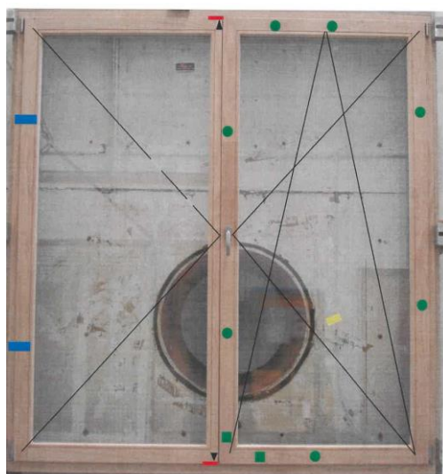
Illustration 6 : Essais AEVM sur porte-fenêtre en chêne rouge
